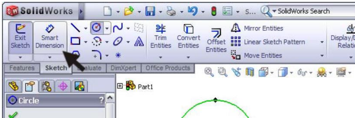
١٢. انقر بالماوس على أي نقطة على الدائرة، ثم حرك الماوس في الاتجاه الذي تريد ان تظهر فيه الأبعاد و قم بالنقر بالماوس لتظهر الأبعاد مثلا فوق الدائرة.
